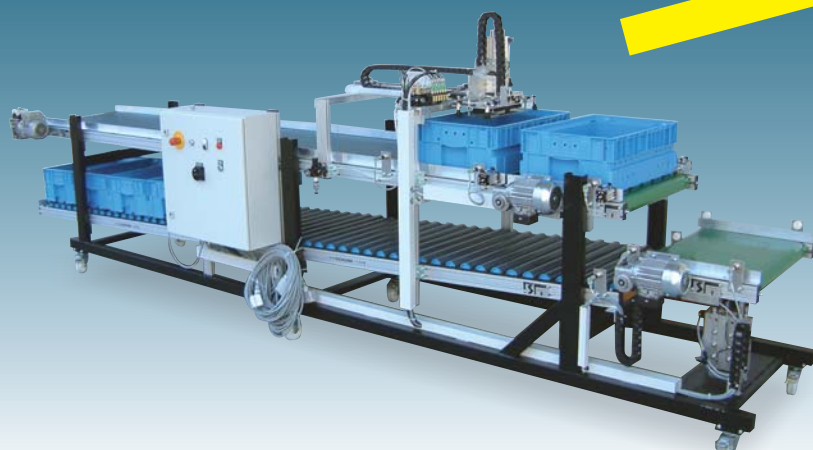
SCHUMA-Etagenanlage mit Lift und Zwischenlagenübersetzer
